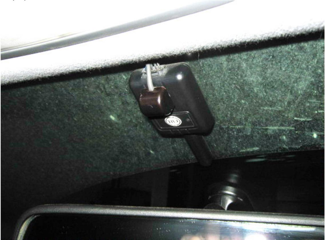
Здесь же, в районе средней стойки, в гофру входит провод активации RGB-входа блока навигации. Я проложил его к блоку навигации под напольным покрытием, вдоль существующих проводов, для этого достаточно было чуть отогнуть покрытие вдоль порога, и протянуть гофру с проводом к блоку навигации.
