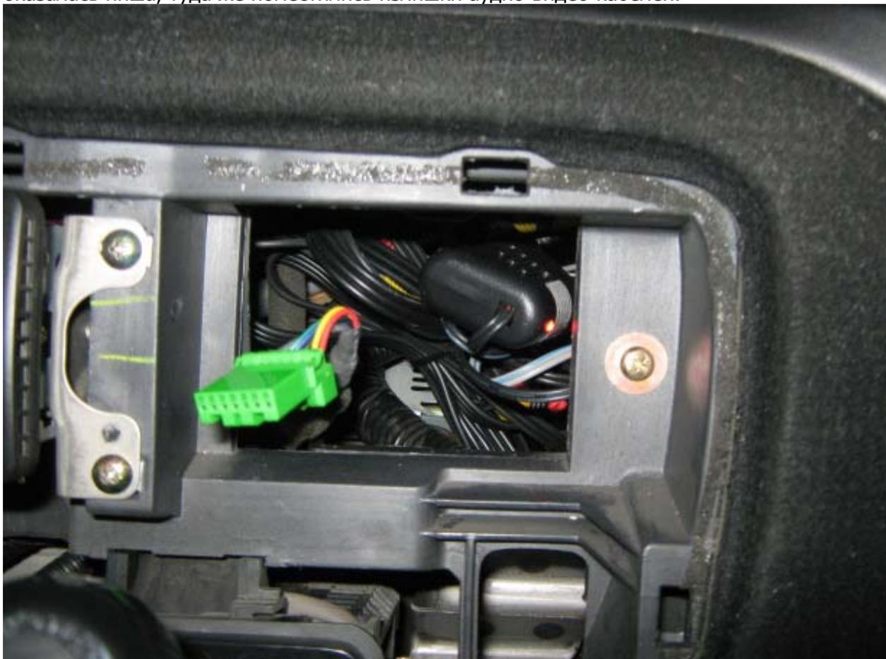
Питание взял от цепи питания эл. розетки в багажнике, после реле, подключился в районе блока предохранителей со стороны водителя (бело-красный провод в жгуте проводов внизу передней водительской стойки).
