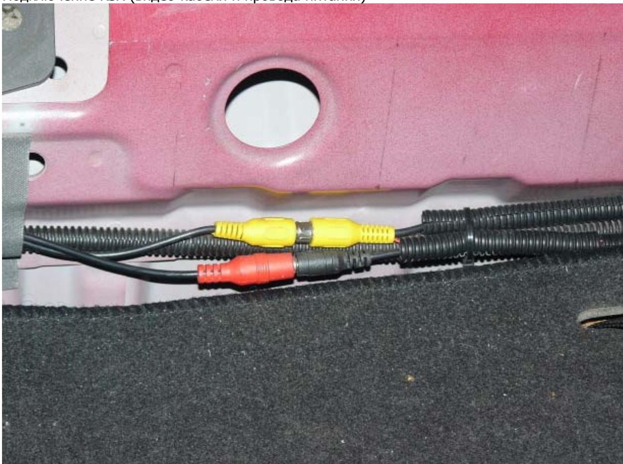
Провод от КЗХ протянул через отверстие для провода подсветки заднего номерного знака.
