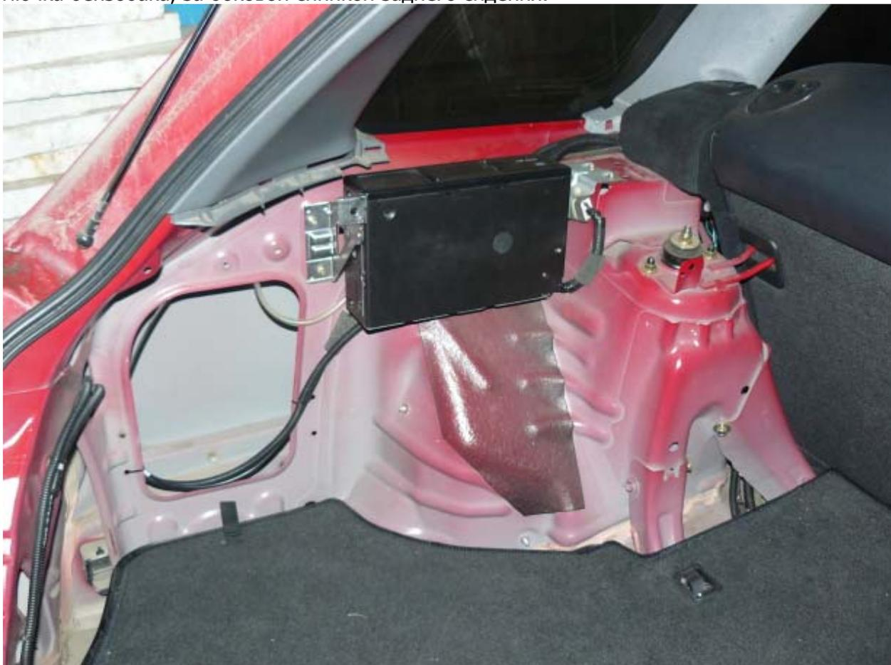
Подключаем провода активации входа КЗХ к лампе заднего хода (я использовал красный провод) и провод активации входа камеры обгона к лампе левого поворота (желтый провод). Эти провода будут активировать видео-входы КЗХ и КО на Абсолюте, и переключать Абсолют из любого состояния на нужный видеовход.
