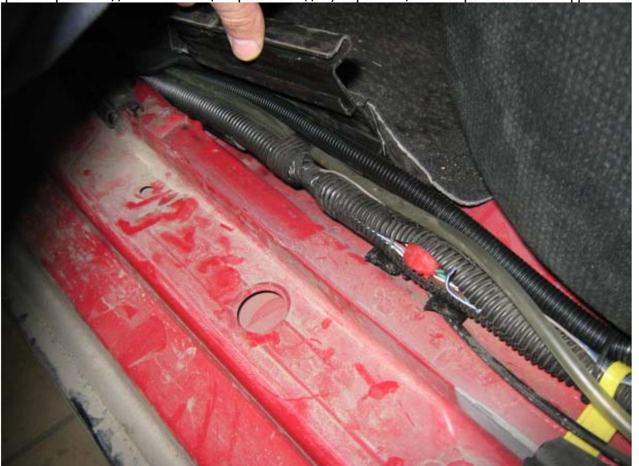
Датчик ДУ Абсолюта решил установить на антенне сигнализации, поэтому протаскивал его по средней стойке вверх и далее под обшивкой потолка к антенне. Снимал только верхнюю боковую ручку пассажира и верхнюю накладку левой передней стойки, козырек снимать нет необходимости – между обшивкой потолка и молдингом ветрового стекла у меня была довольно большая щель, позволившая без усилий протолкнуть за обшивку провод.
