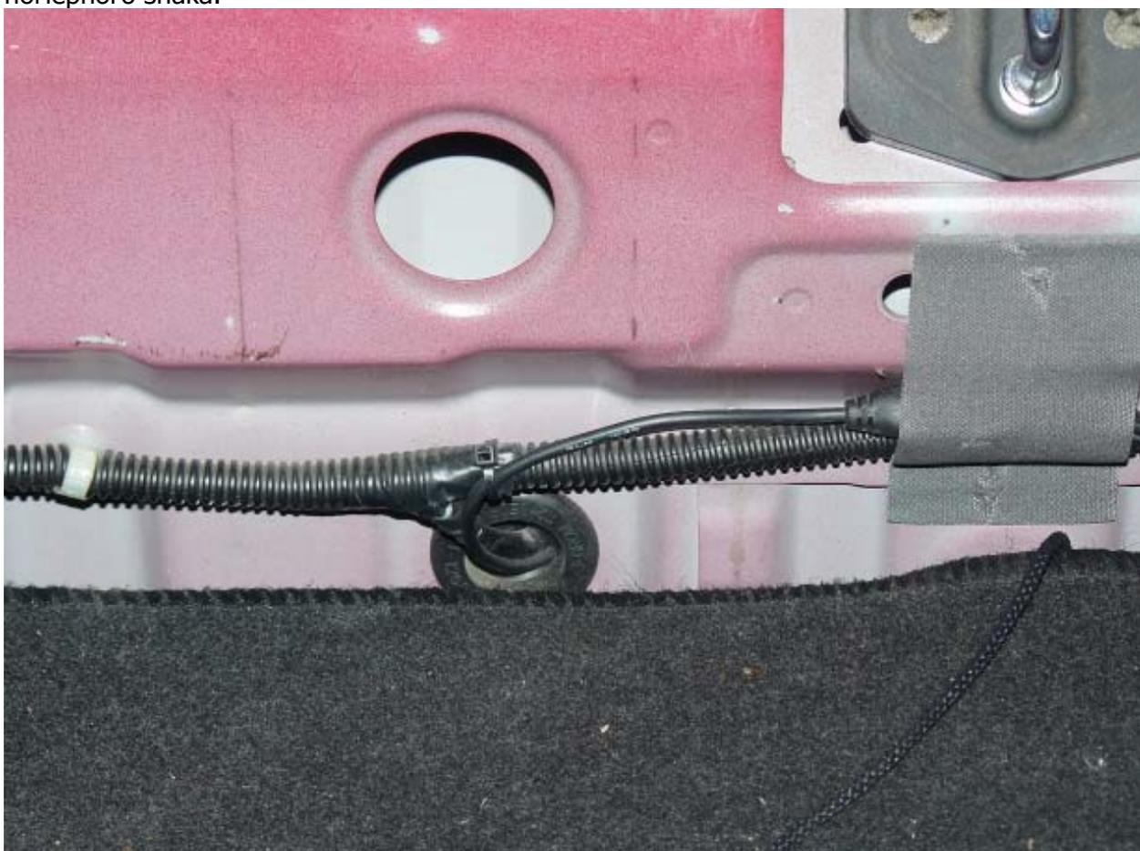
КЗХ прилепил на двухсторонний скотч под задним номерным знаком. Пока держится. Скотч уже выдержал несколько автоматических моек под давлением.
