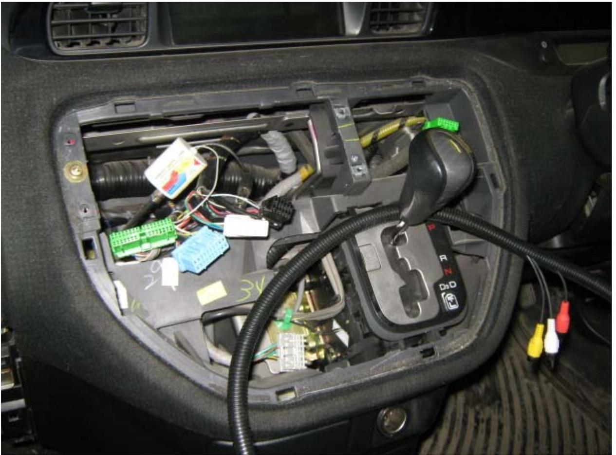
При включении заднего хода провод активации RGB-входа через нормально разомкнутое реле замыкается на "массу". Управляющий сигнал +12В от задних фонарей беру в блоке предохранителей водителя (контакт 6 разъема 42). Подключение к "массе" – под штатным болтом крепления. Реле расположил там же.
