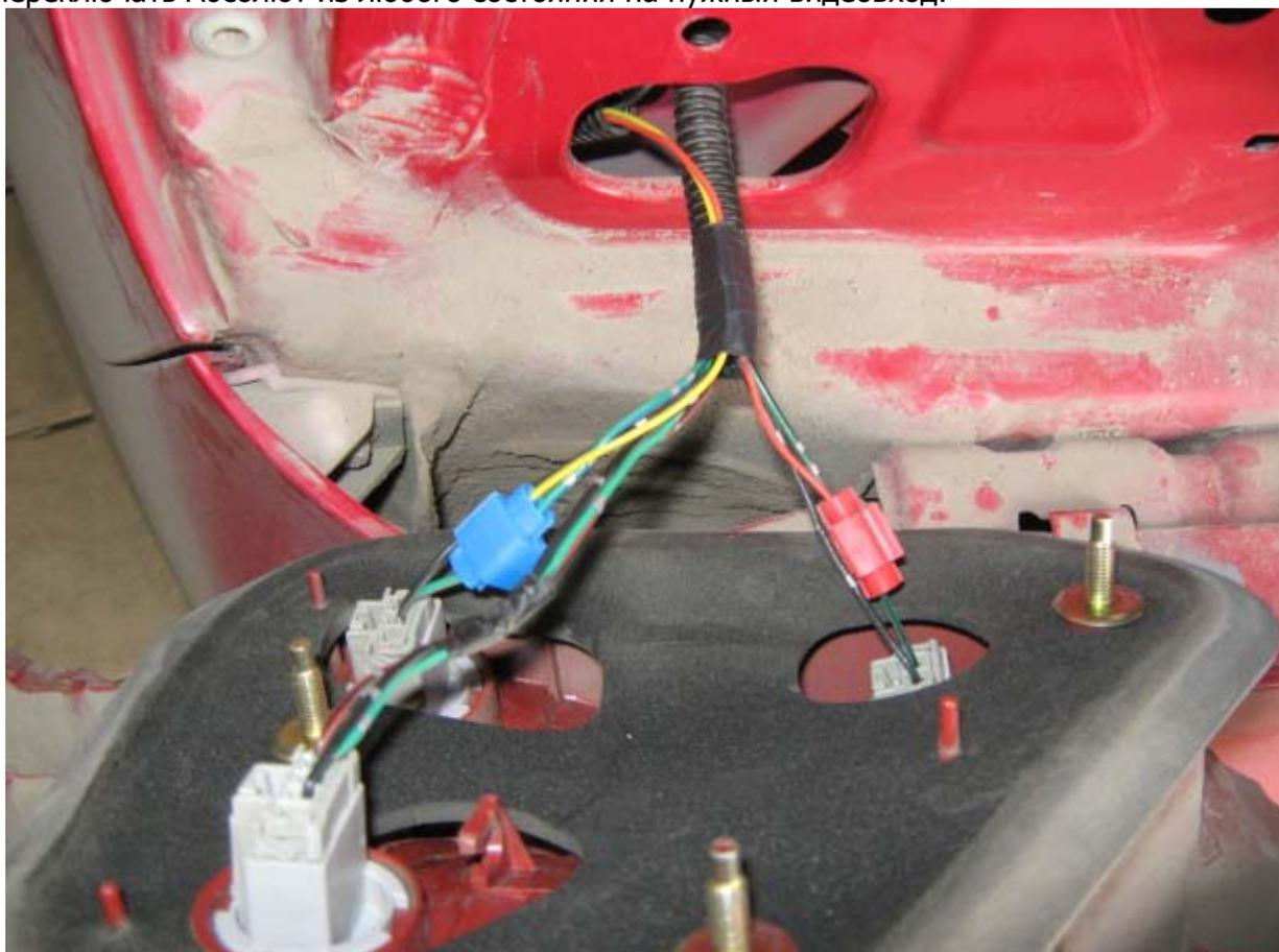
Подготовленный видео-кабель для подключения КЗХ. Красный провод, торчащий из RCA-штекера – провод питания КЗХ (видео-кабель из комплекта КЗХ экономит провод питания)
